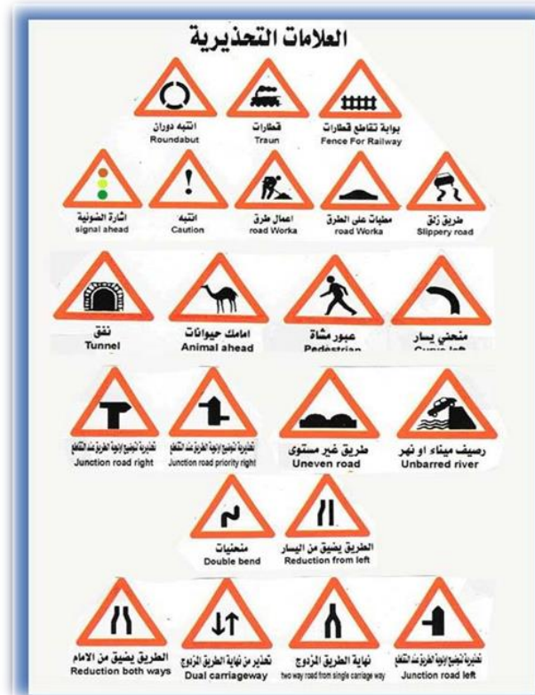
شكل 6.2 : صورة توضح إشارات المرور التحذيرية
