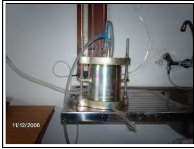
(12): تجربة النفاذية بطريقة ضغط الماء المتغير
