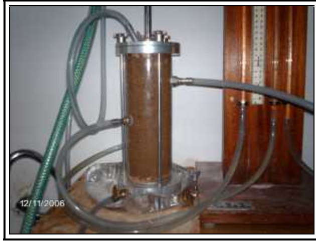
(13): تجربة النفاذية بطريقة ضغط الماء
