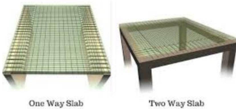
الشكل (3-5) العقدات المصمتة ذات الاتجاه الواحد والاتجاهين.
