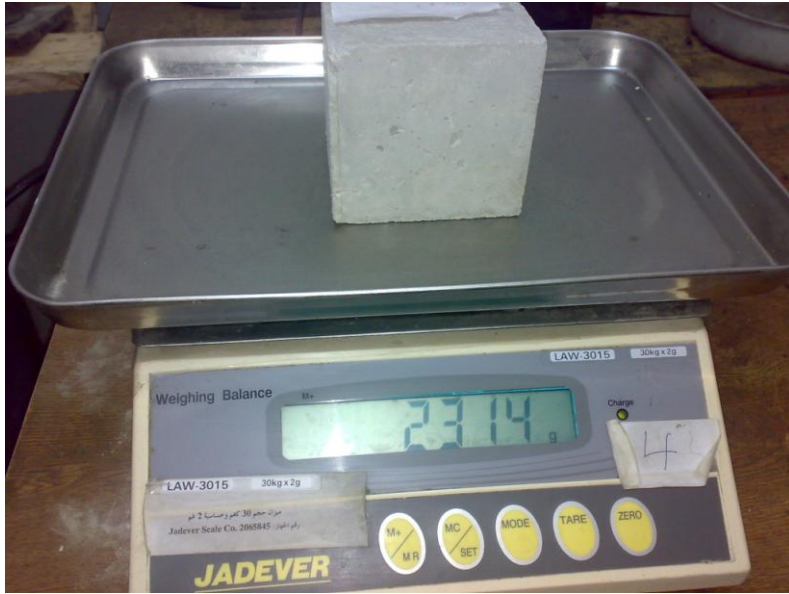
الشكل (14): مكعب اختبار مقاومة الضغط خلال عملية قياس الوزن
