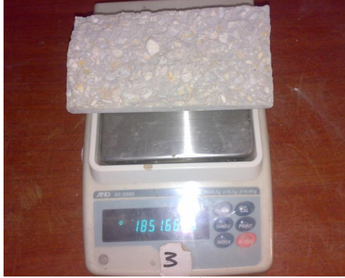
الشكل (29): عينة خلال قياس وزنها الجاف
