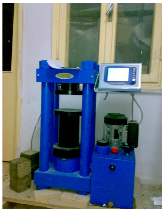
الشكل (6) : جهاز الضغط المستخدم في كسر العينات
