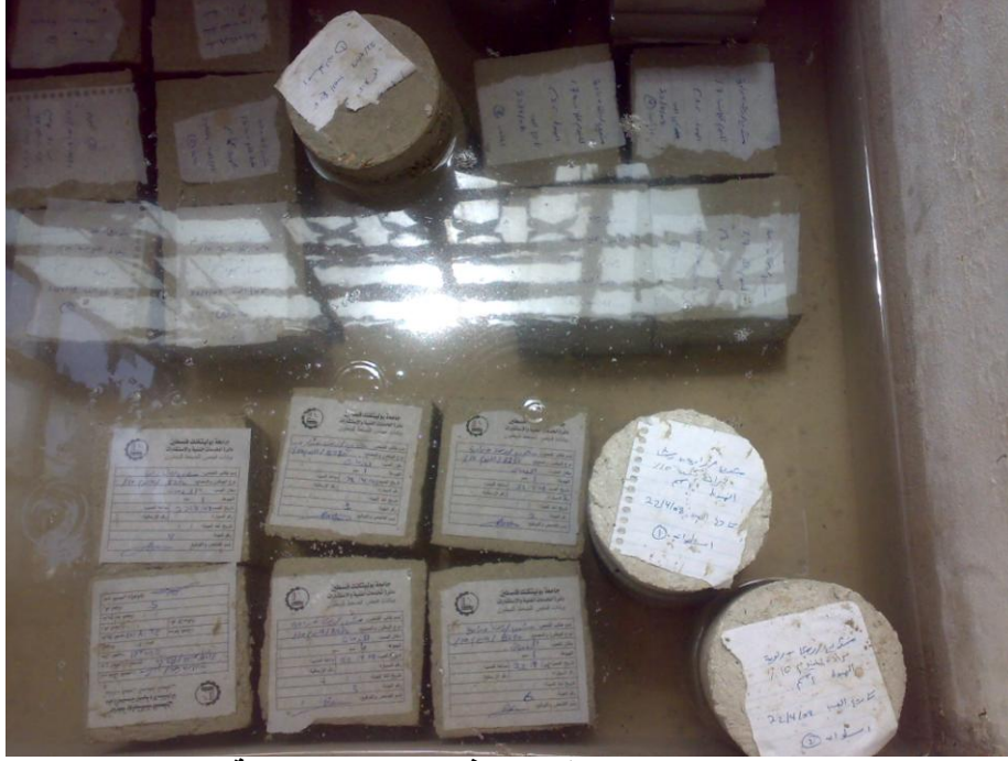
الشكل (13) : مكعبات واسطوانات في حوض المعالجة تحت الماء
