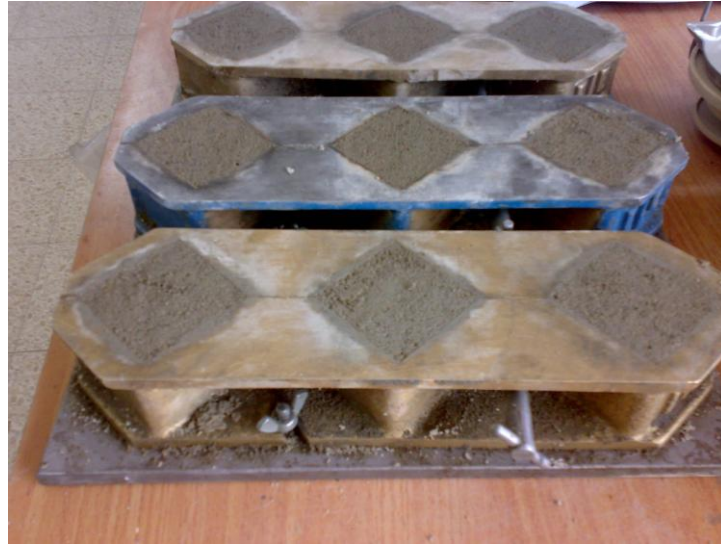
الشكل (32) : مكعبات المونة الاسمنتية في القوالب
