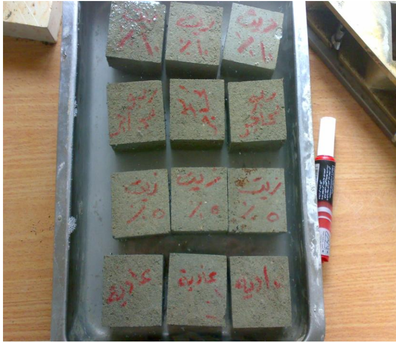
الشكل (33) : عينات المونة الإسمنتية مغمورة بالماء
