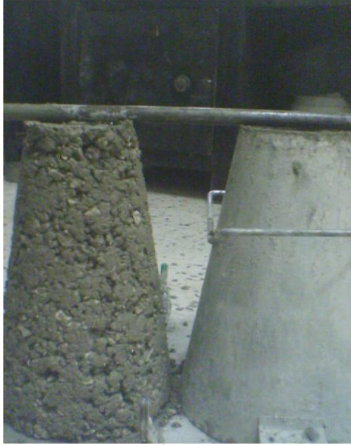
الشكل (31) : عملية قياس الهبوط
