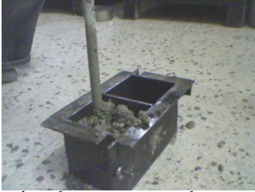
الشكل (11) : عملية الدمك لقالب مكعبات اختبار مقاومة الخرسانة للضغط
