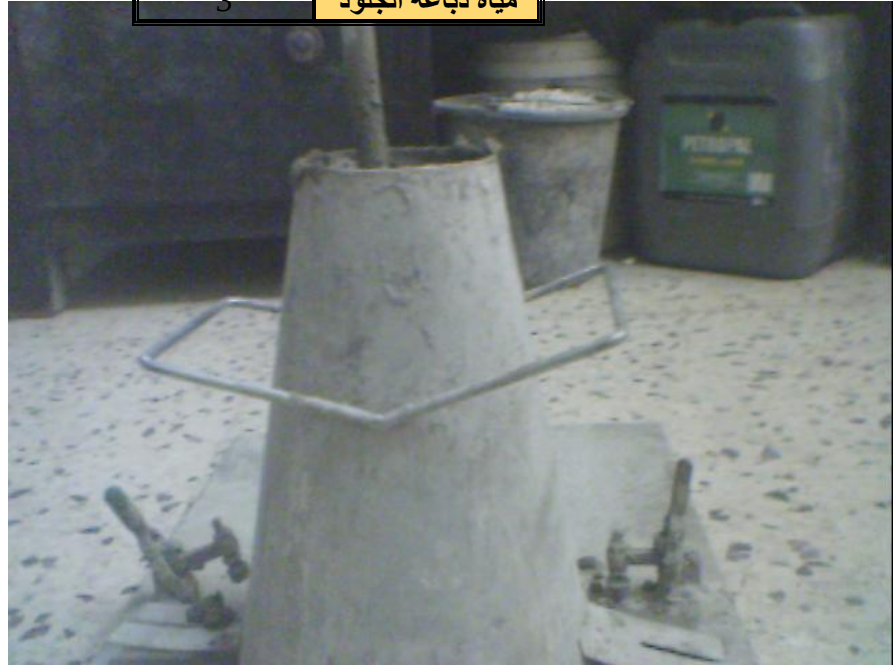
الشكل (30) : عملية الدمك في اختبار الهبوط
