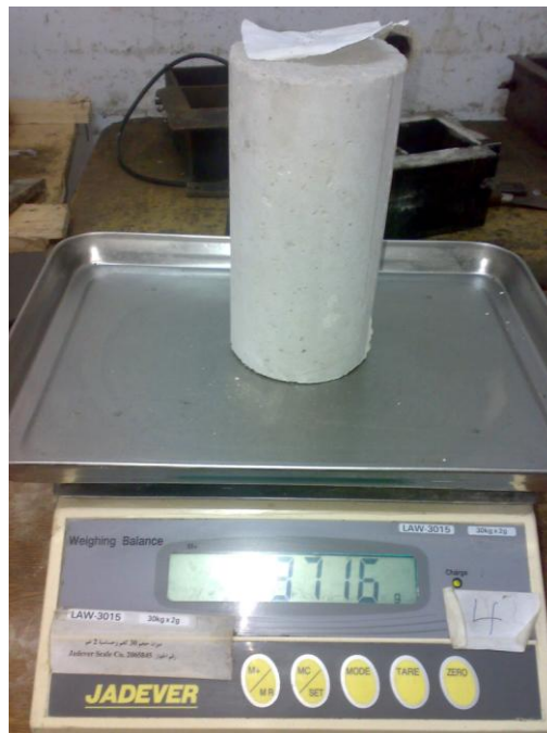
الشكل (15): اسطوانة اختبار مقاومة الشد خلال عملية قياس الوزن
