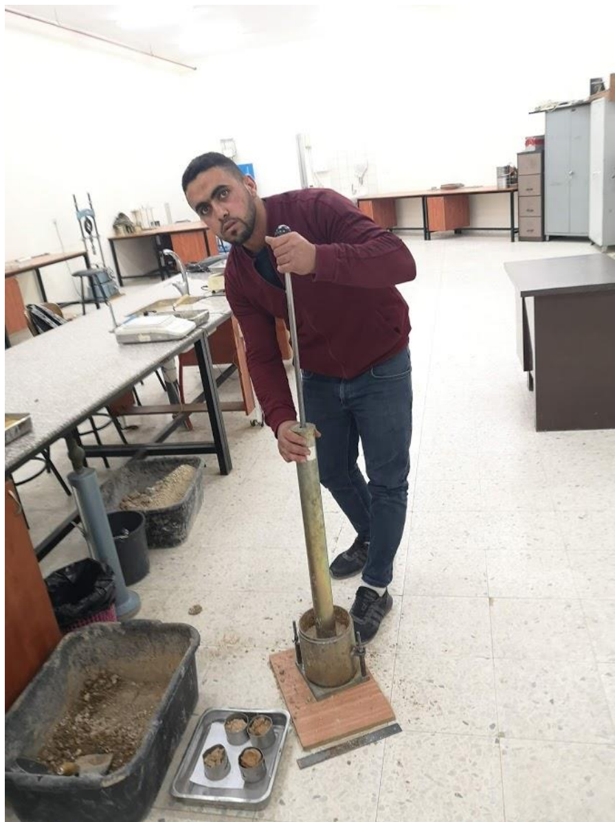
الشكل (2-5) صورة اثناء القيام بتحديد الكثافة العظمى
