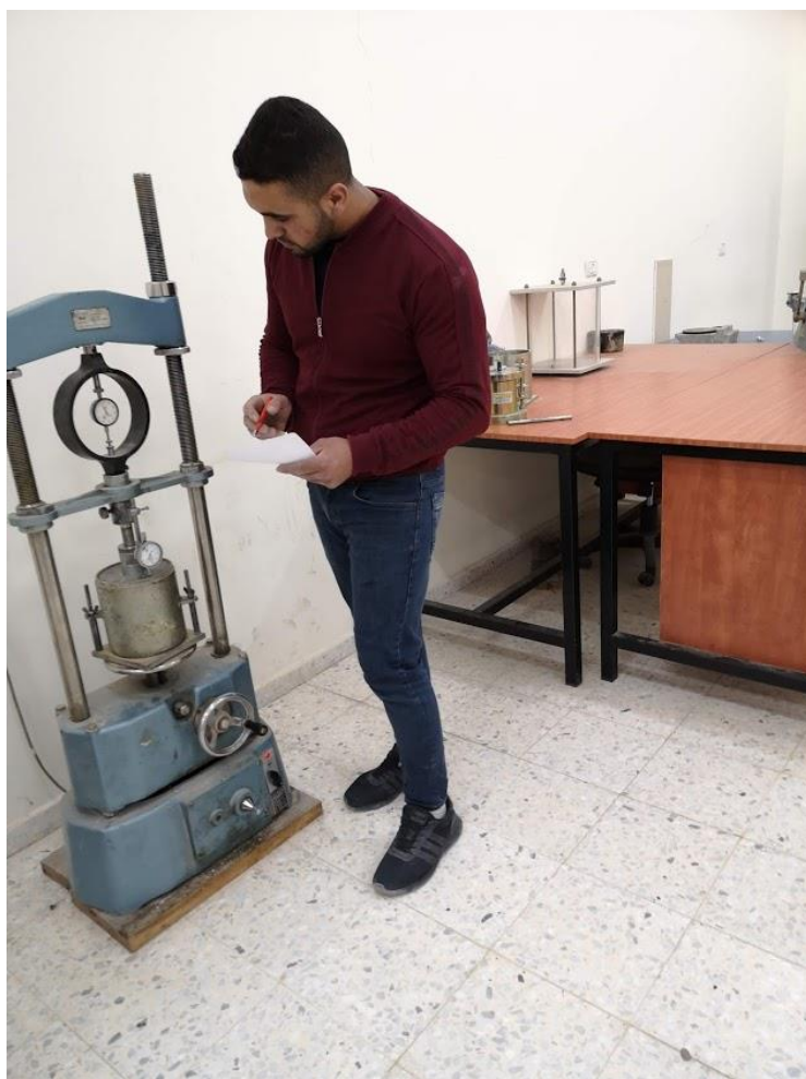
الشكل (5-5) صورة اثناء القيام بتجربة CBR
