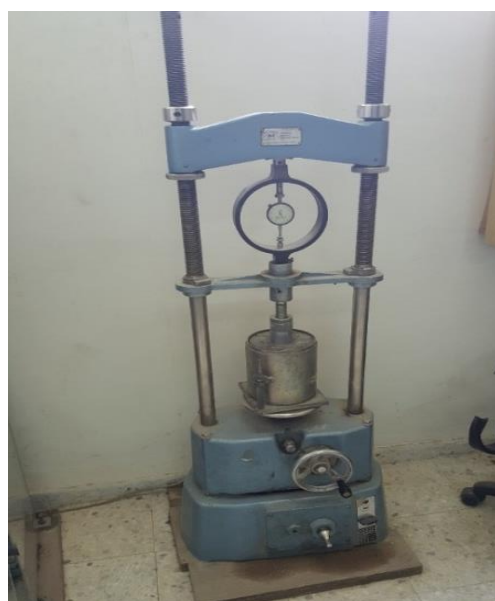
الشكل (6-5) جهاز فحص CBR .
