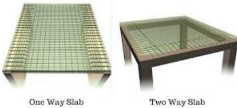
الشكل (٣-٥) العقدات المصمتة ذات الاتجاه الواحد والاتجاهين.
