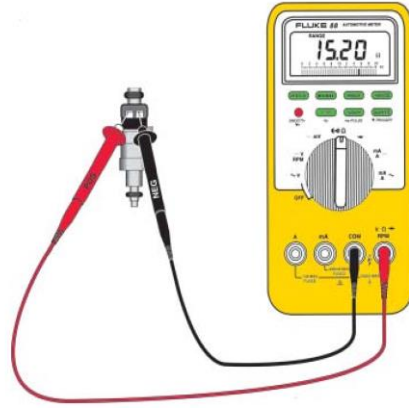
الشكل 5.2: فحص مقاومة حاقن الوقود
