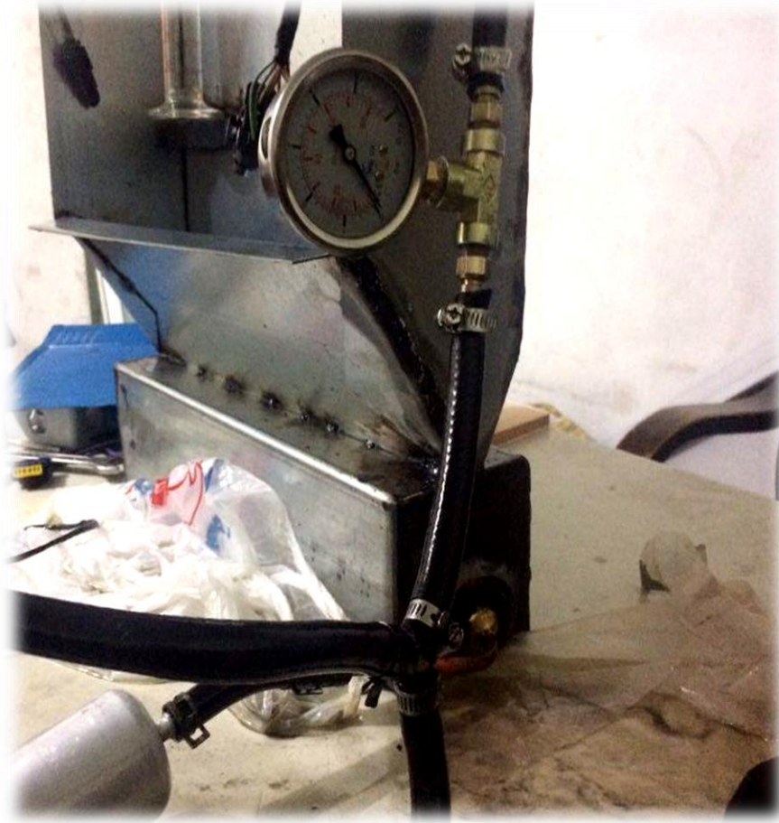
الشكل 3.2: خزان الوقود
