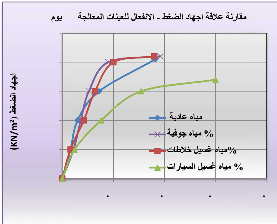
مقارنة نتائج الخرسانة المصنوعة بالمياه العادية والخرسانة المصنوعة بنسبة % باقي المياه
