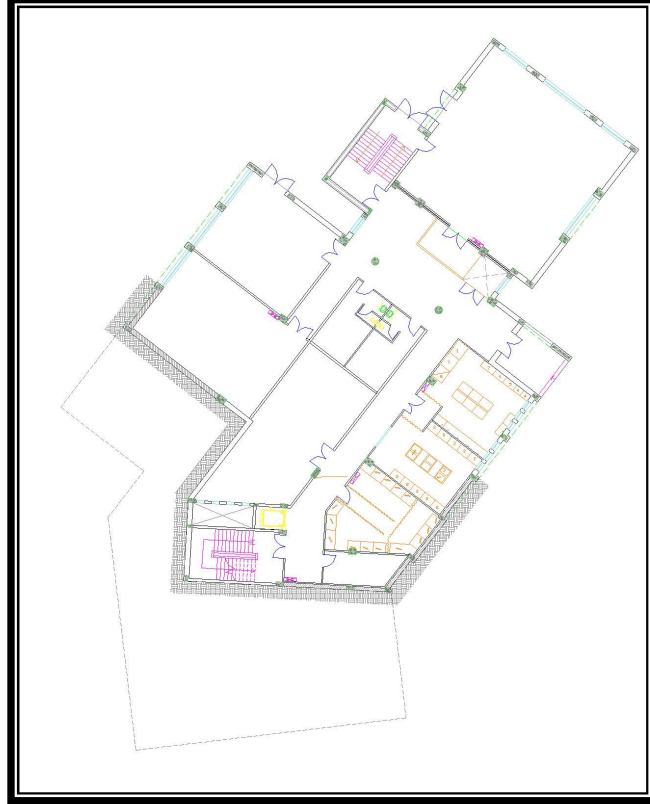
الشكل (3-2) المسقط الأفقي لطابق التسوية.
