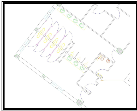
الشكل (2-14) المسقط الأفقي لإحدى الوحدات الصحية.
