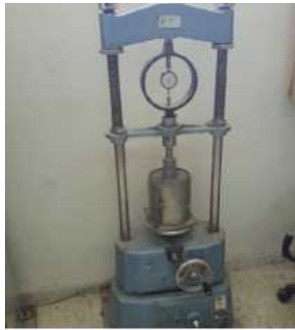
شكل (١-٢) جهاز فحص CBR .
