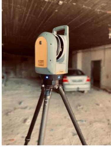
شكل(2): جهاز LiDAR X7
