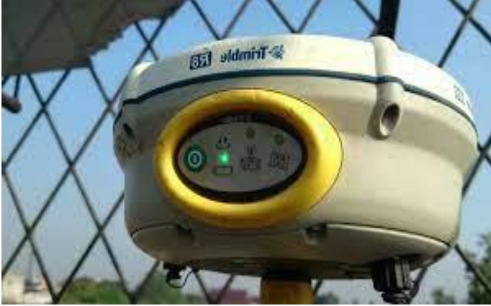
صورة (2-1) توضح شكل جهاز ال (GPS) و نوعه (Trimble R8)
