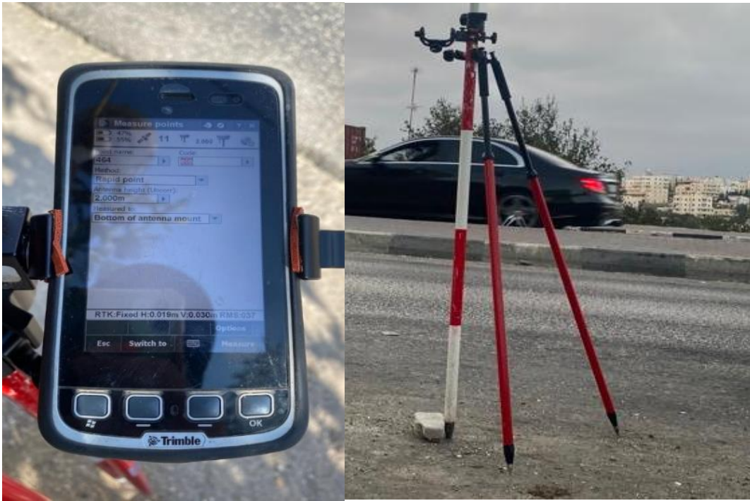
صورة (2-1) توضح شكل جهاز ال (GPS) و نوعه (Trimble R8)
