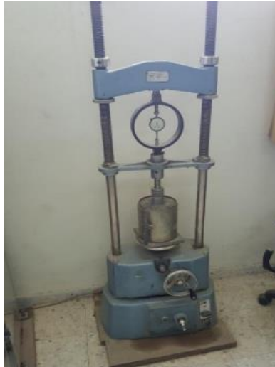
الشكل(٦-٢) : جهاز فحص CBR
