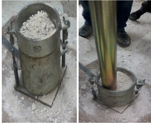
الشكل (6-2) : الأعمال المخبرية لتجربة بروكتور. [4]
