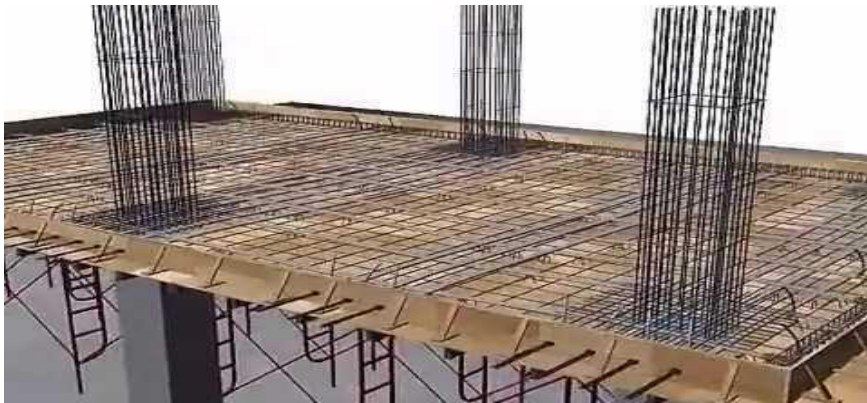
شكل (٣-٣) توضح عقدة مصمتة باتجاه واحد
