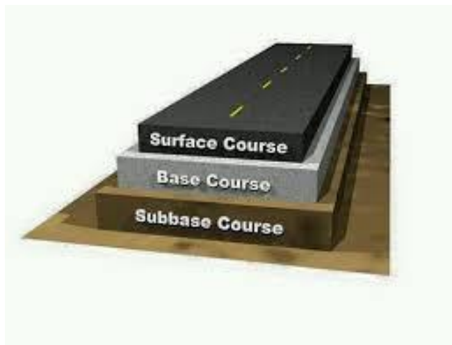
رسم توضيحي 0.5: طبقات الرصفة المرنة.
