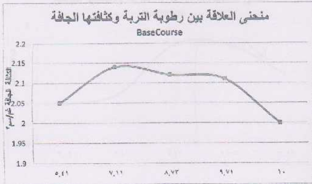
شكل (٣-٥) منحنى العلاقة بين رطوبة التربة وكثافتها الجافة.
