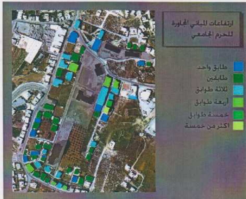
الشكل (٤-٦) ارتفاعات المباني المجاورة (المصدر: فريق العمل)
