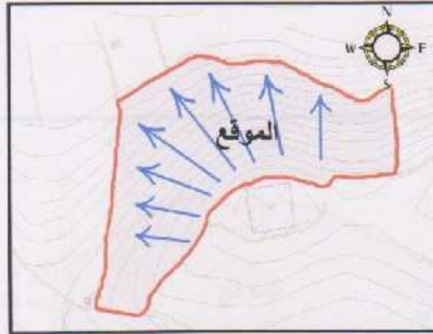
الصورة (2-16) : تصريف المياه في الموقع
