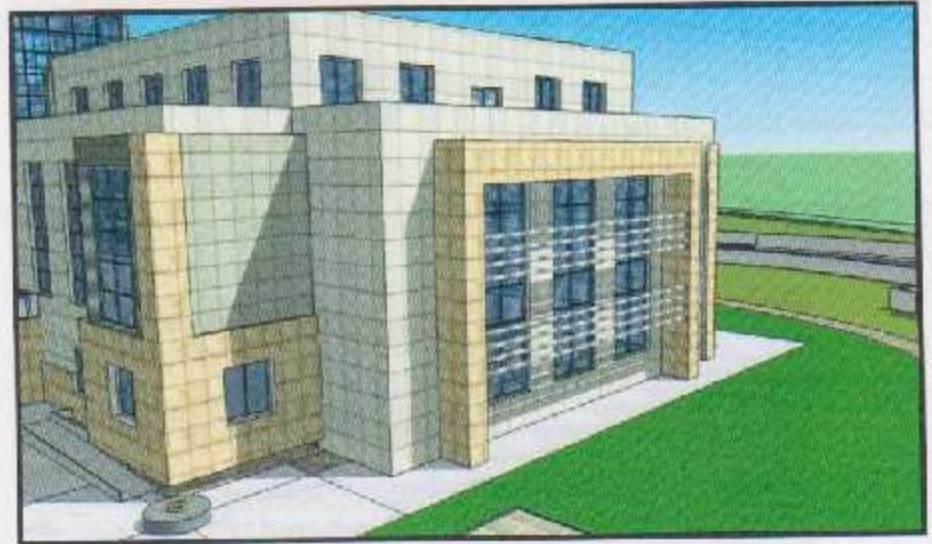
الشكل (٢٠٣-٢-٨) : البروزات الحجرية التي تأخذ شكل الأطر في الواجهة الجنوبية
