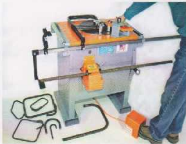
الشكل (١.١٠): الطاولة الميكانيكية لثني قضبان الحديد.
