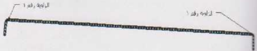
الشكل (٣.٤٣) قضيب الحديد بعد عملية الثني في المرحلة الأولى
