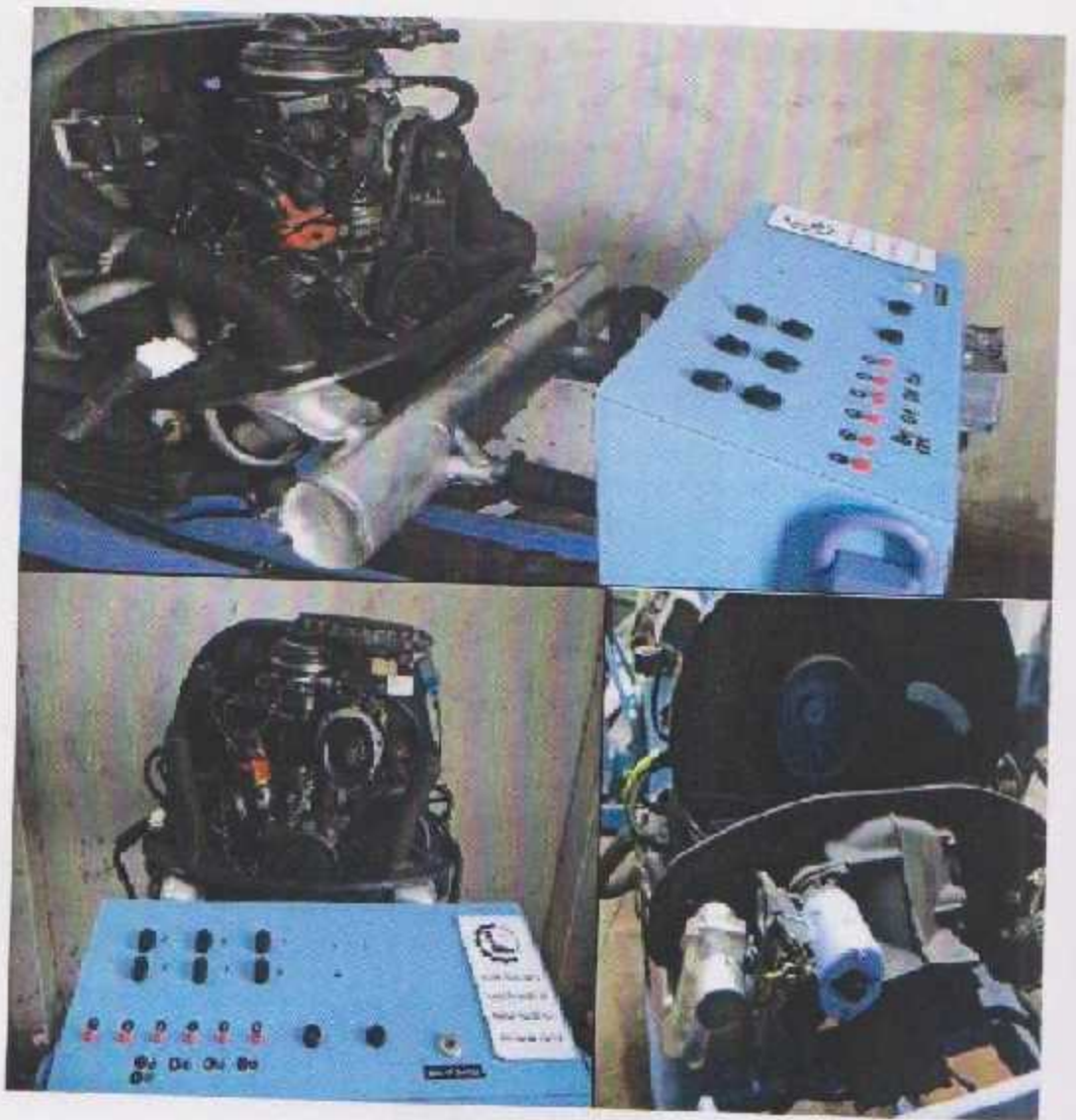
الشكل (٢-٥) : نموذج تعليمي لنظام حقن وقود أحادي غير مباشر
