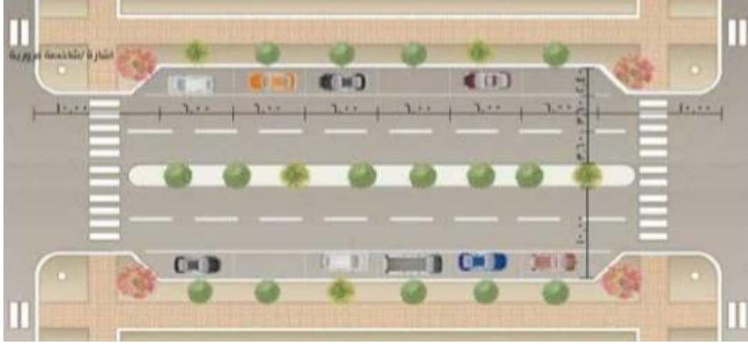
صورة رقم (4-6): مخطط أفقي يبين حارتين لوقوف السيارات من خلال توفير خليج خاص (8) .
