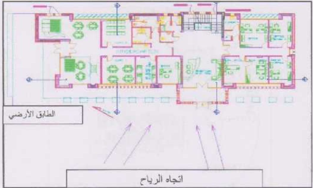
شكل (5-19) التهوية الطبيعية عن طريق الفتحات المباشرة (الأبواب والشماعات) المصدر: (مصلحة الطاقة الفلسطينية، 2014-12-3)
