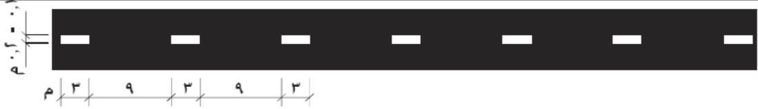
أ - خط منتصف الطريق المتقطع في منطقة ريفية
