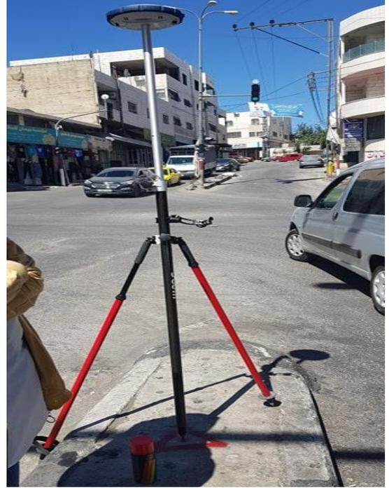
شكل (2-3) : جهاز GPS نوع SP60
