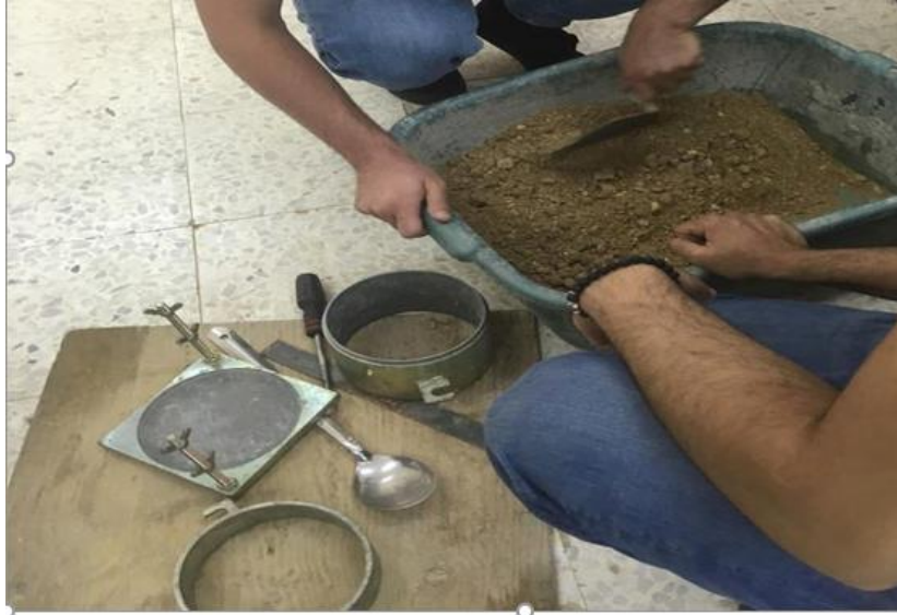
الشكل (2-6) اثناء القيام بتجربة الكثافة العظمى
