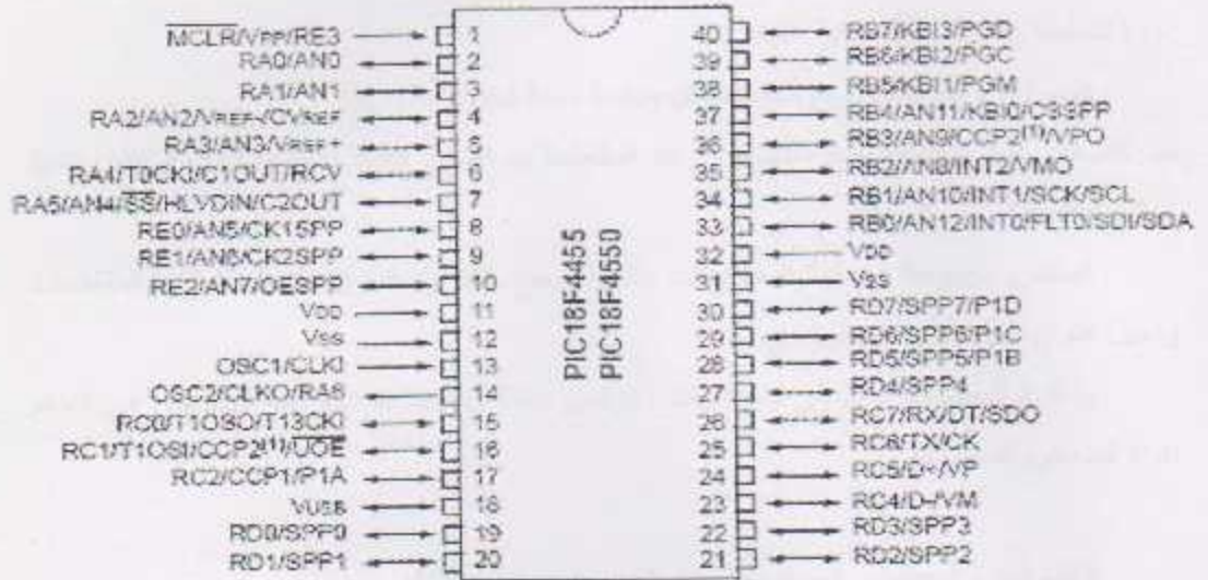
شكل (2.6) أقطاب المتحكم PIC 18f4550
