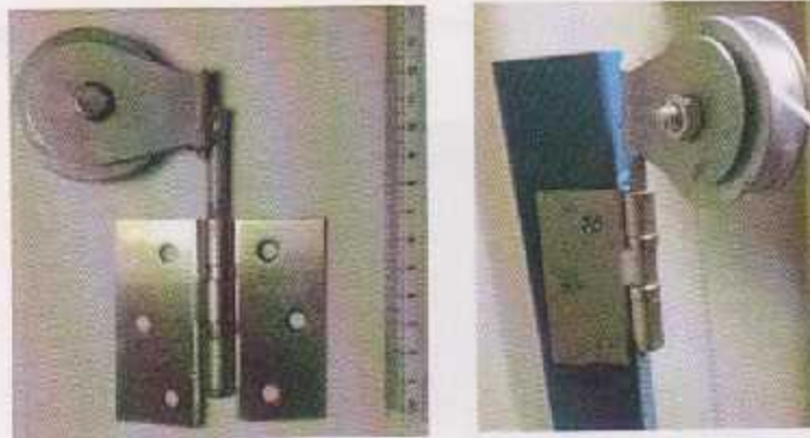
Fig (3.9) Cable pulley
