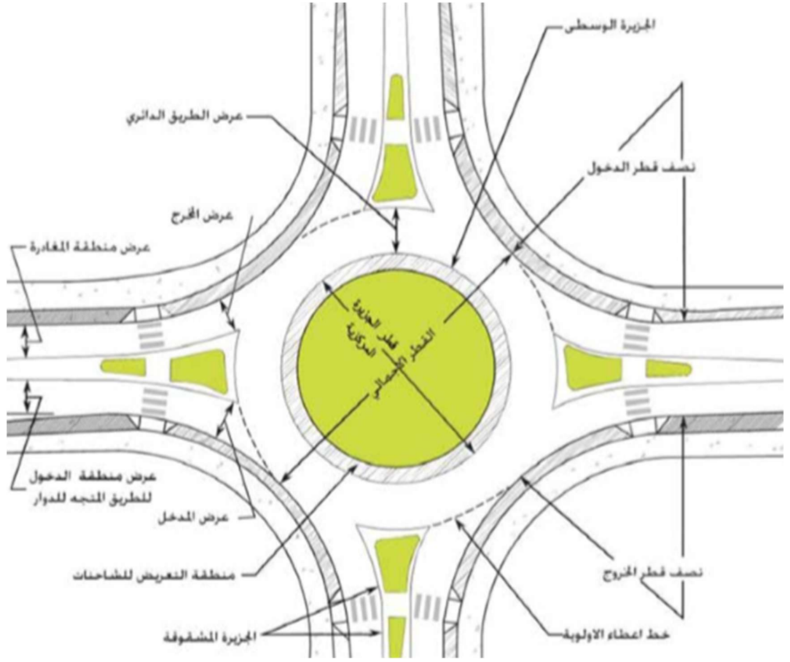
الشكل ٣-٥: العناصر الهندسية الأساسية للدوار. [13]
