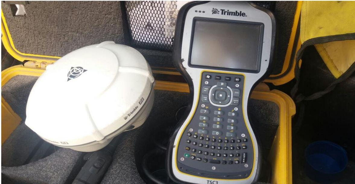
الصورة رقم (٢-١١) الجهاز المستعمل في عملية الرفع المساحي (الجهاز المستخدم Trimble R8)
