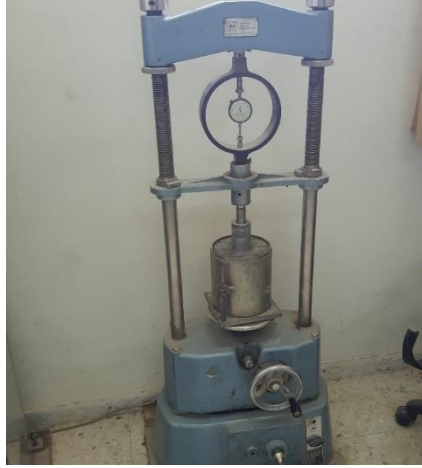
الشكل (٢-٥) جهاز فحص CBR .
