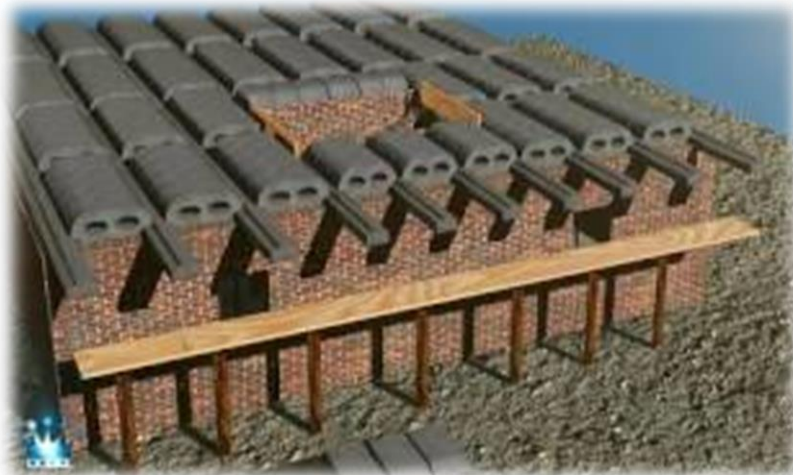
الشكل (٥-٣): عقدات العصب ذات الاتجاه الواحد.
