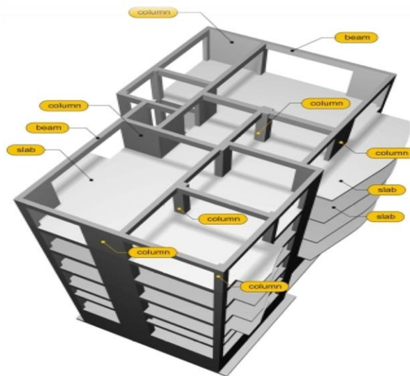
الشكل (3 - 3): رسم توضيحي للعناصر الإنشائية.
