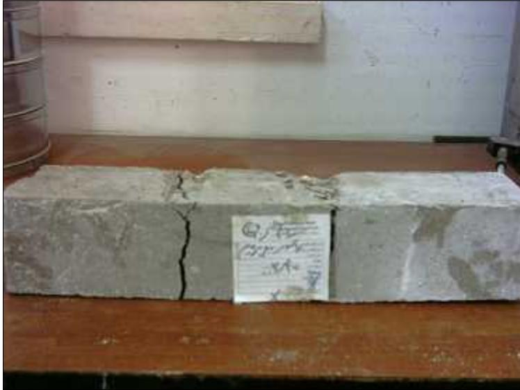
( - - - ) :شكل الكسر في عينة تحتوي فولاذ مبزر يحتوي باكور وانبوب بلاستيكي
