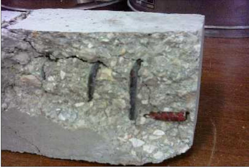
( - - - ) :شكل الكسر في عينة تحتوي على حديد مبزر مغطى بدهان زيت لميع بعد انهيارها بعد أيام
