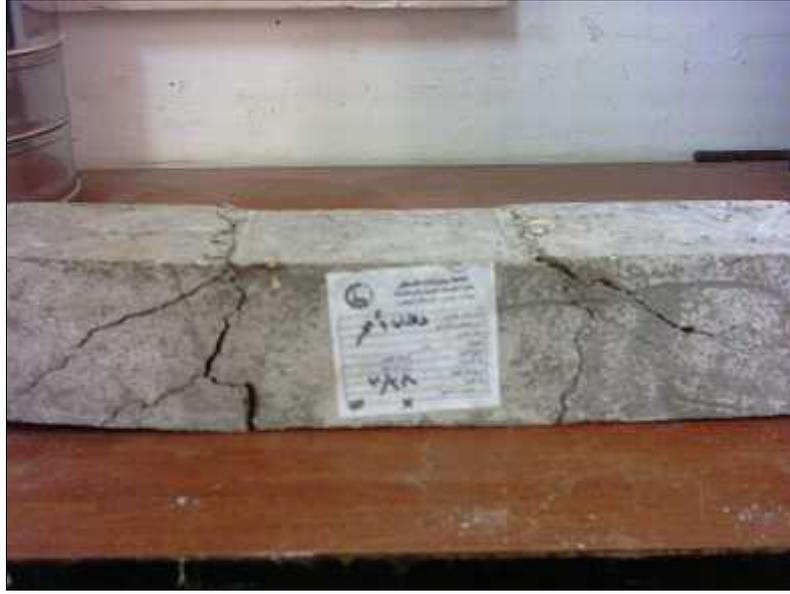
( - - - ) : الكسر في عينة تحتوي على حديد مبزر مغطى بدهان زيت لميع بعد انهيارها بعد اختبار أيام
