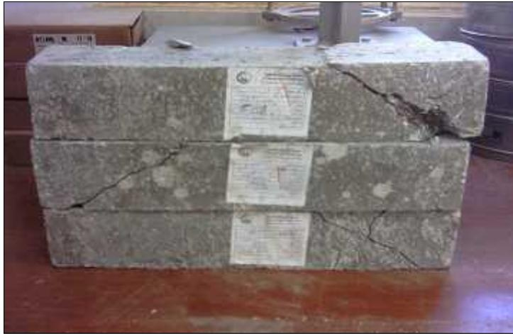
( - - ) : العينات التي تحتوي على فولاذ يغطيه بعد انهيارها بعد اختبارات
