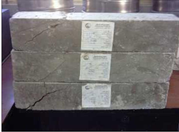
( - - ) : شكل الكسر في العينات التي احتوت على فولاذ نظيف بعد اختبارات ايام
