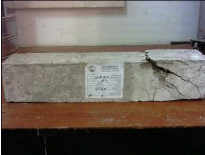
( - - - ) : شكل الكسر في عينة تحتوي على حديد مبزر مغطى بدهان زيت لميع بعد انهيارها بعد اختبار أيام
