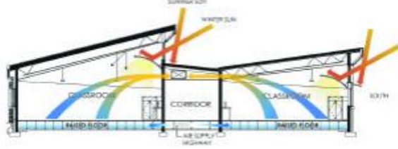
شكل(3.4) يوضح الرفوف الضوئية الداخلية في فراغات مدرسة فورك
