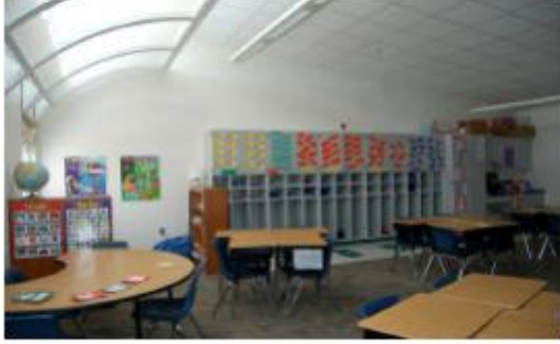
شكل(3.4) يوضح الرفوف الضوئية الداخلية في فراغات مدرسة فورك
