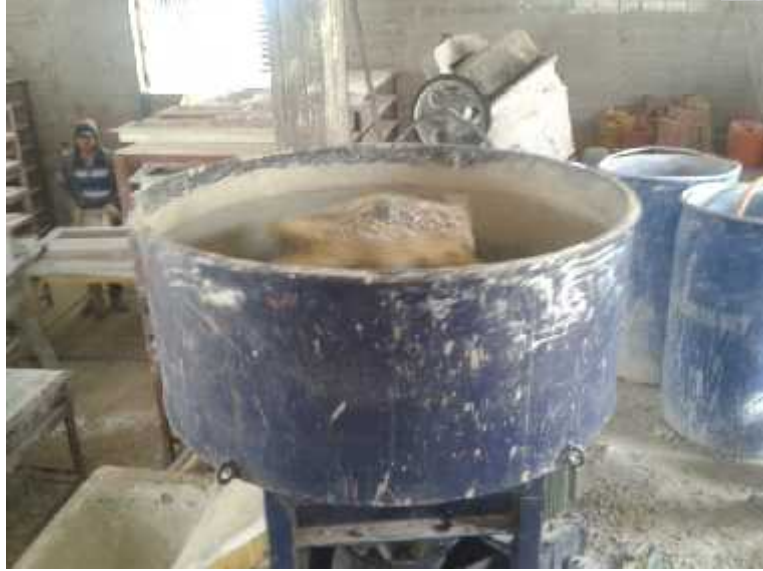
صورة ( - ) : الحصمة أثناء تكسيرها ودوراتها في الخلاطة - اليتيم لمواد البناء - فريق العمل
