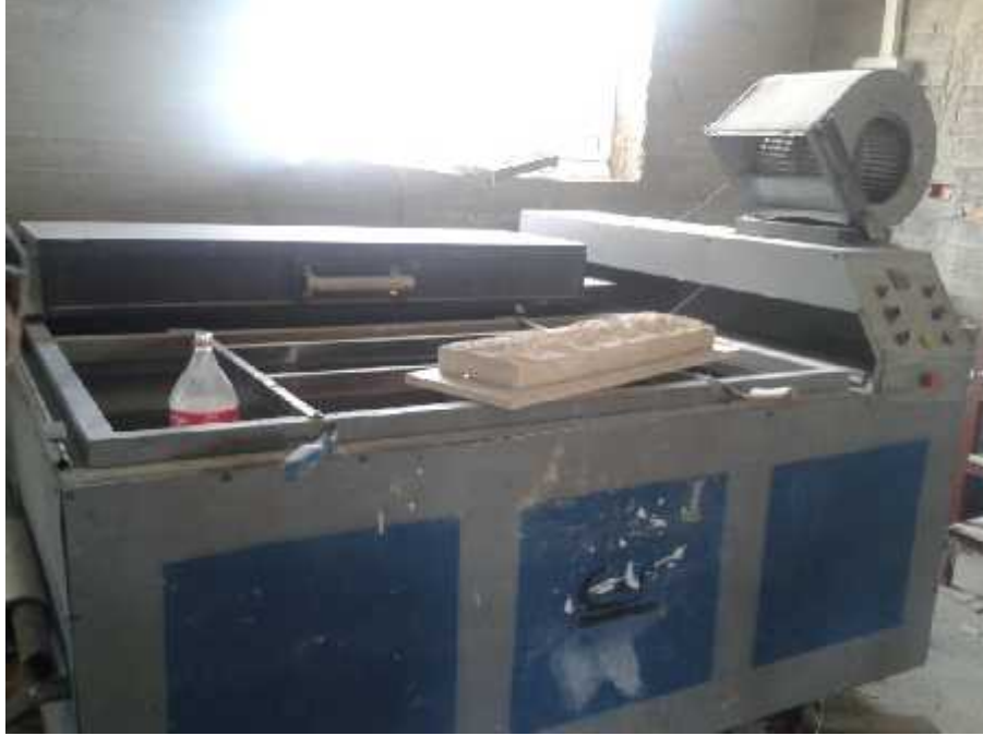
صورة ( - ) :آلة القالب والحجر الطبيعي مثبت على لوح خشبي وجهاز لبيتم صب البلاستيك فوقه - البيتم لمواد البناء - فريق العمل .
