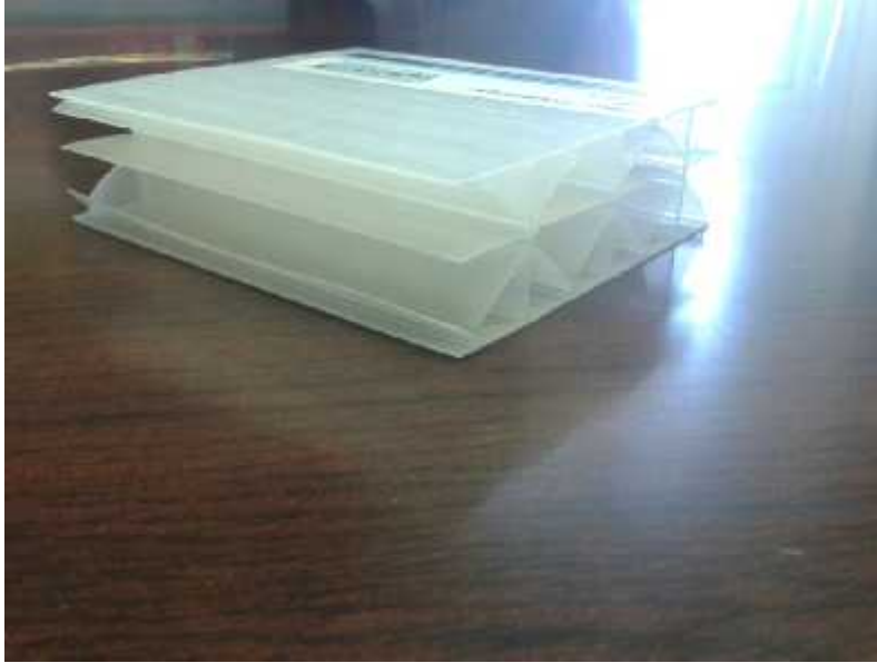
صورة ( - ) :مادة ( Poly carbonate sheet ) التي استخدمت في تغطية السقف - المصدر : مكتب م.هاني الحسن-فريق العمل
