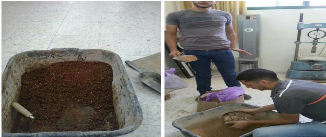
الشكل (2-4) : أثناء العمل في تجربة الكثافة العظمى
