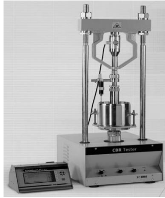
الشكل (3-4) جهاز فحص CBR .
