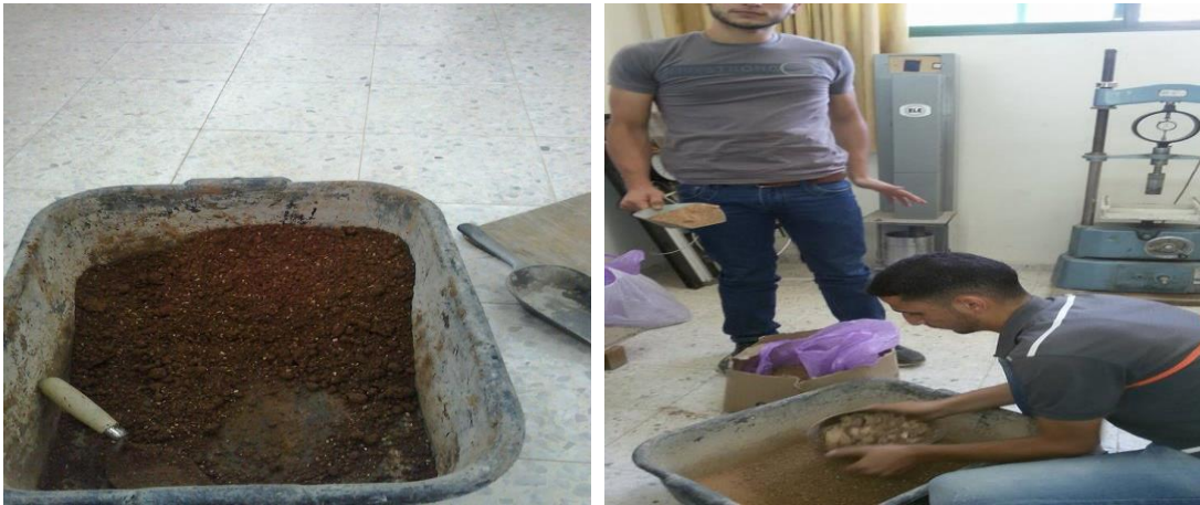
الشكل (2-4) : أثناء العمل في تجربة الكثافة العظمى
