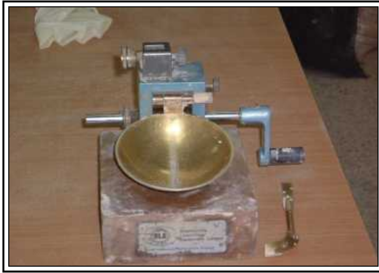
( - ) : جهاز كازاغراندي المستخدم في تجربة حد السيولة
