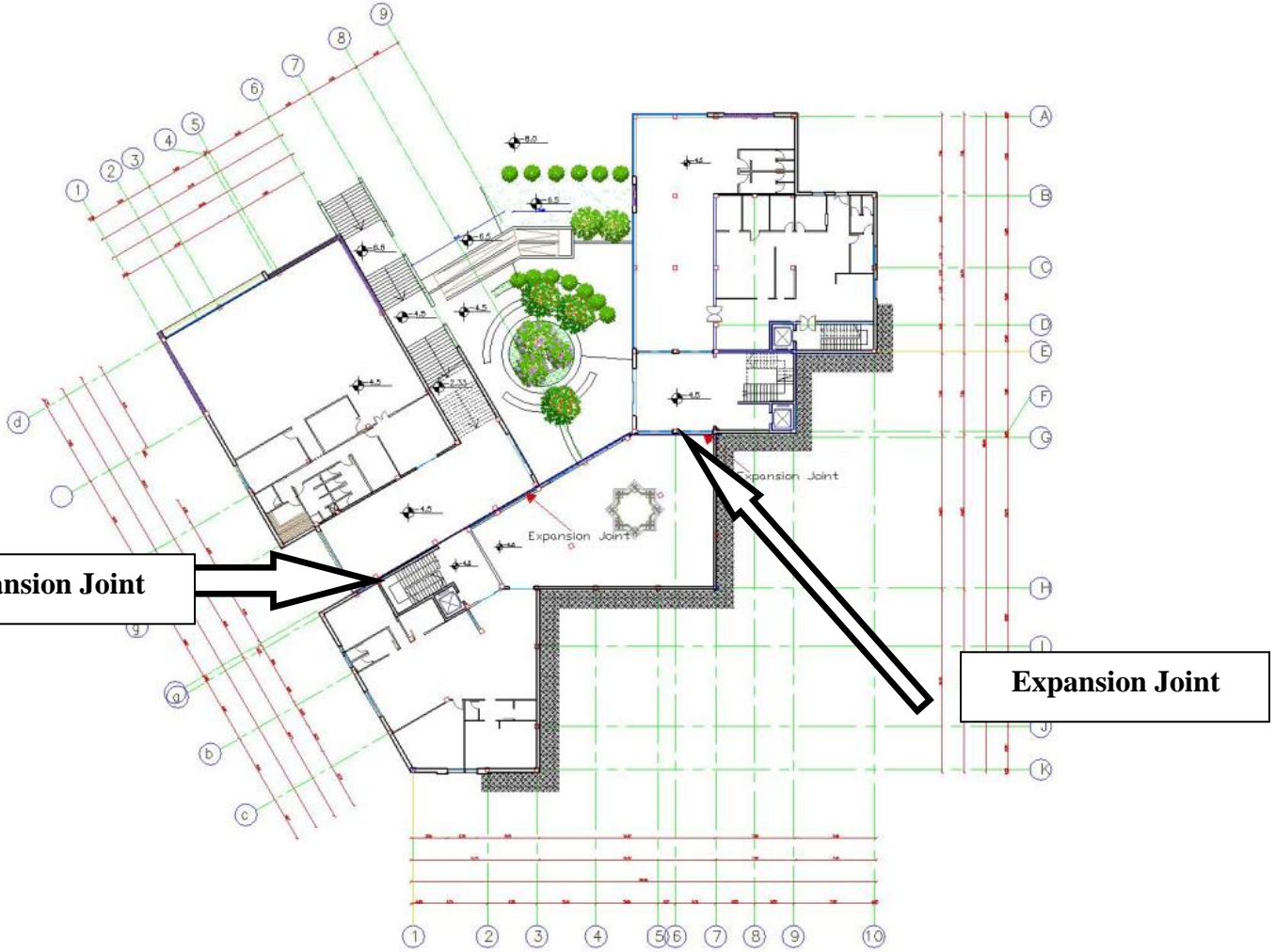
الشكل (3-13) فاصل التمدد بالمبنى.
