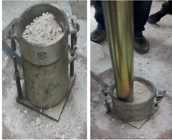
الشكل (2-6) : الأعمال المخبرية لتجربة بروكتور.
