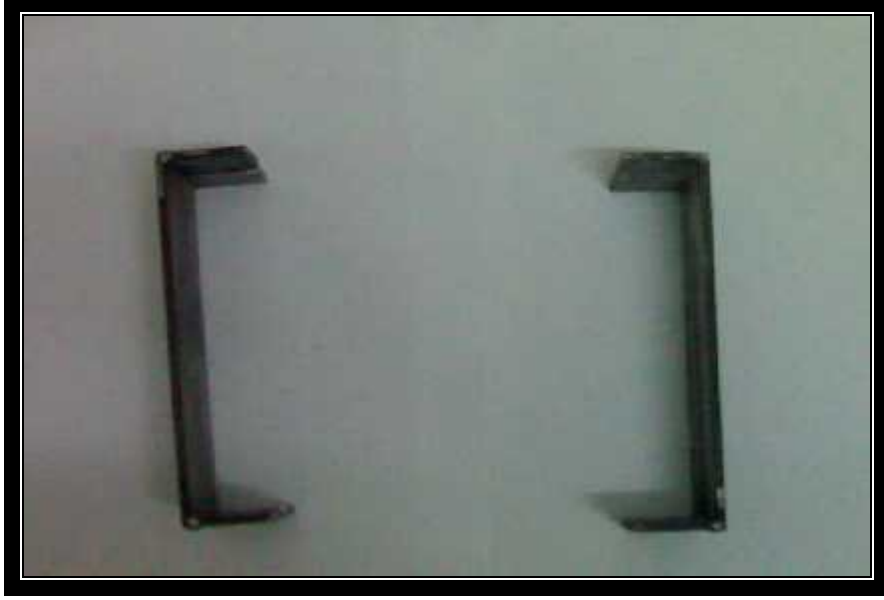
صورة ( - ) : الإطار المعدني المستخدم لحصر عينة الخرسانة أثناء الفحص
