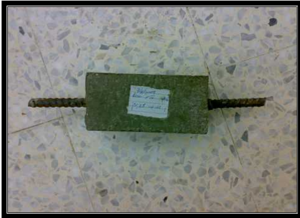
صورة ( 7- ): عينة خرسانة مع قضيب التسليح قبل الفحص
