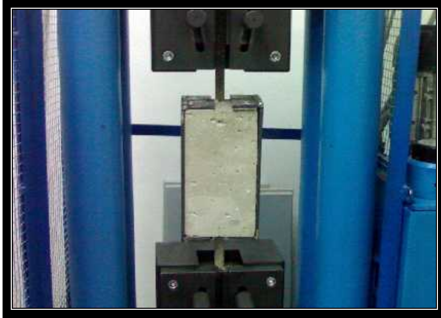
صورة ( 8 - ): اختبار سحب الحديد من الخرسانة موضعا الإطار المعدني لحصر العينة الخرسانية
