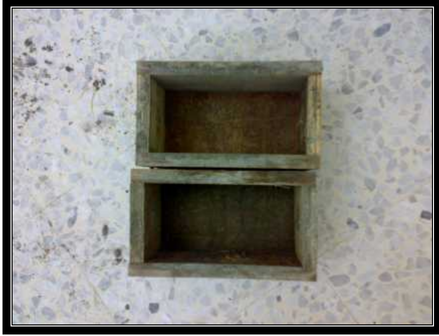
صورة ( - ) : بات الصب للعينات قبل صب الخرسانة بها
