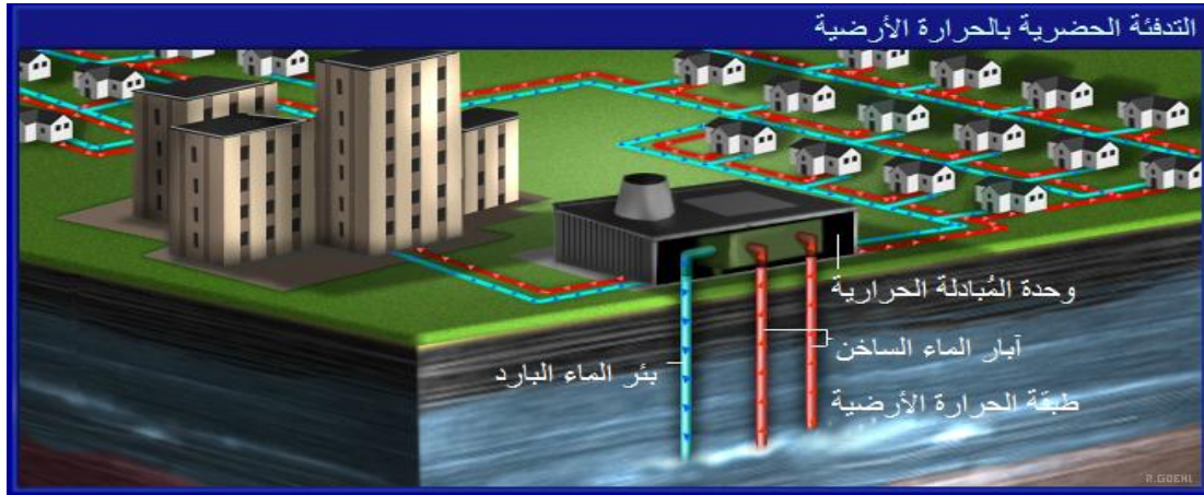
الشكل (1-3): مبدأ عمل التدفئة الحضرية باستغلال الحرارة الجوفية للأرض. المصدر: ( http://www.planetseed.com/ar/node/15398 )
