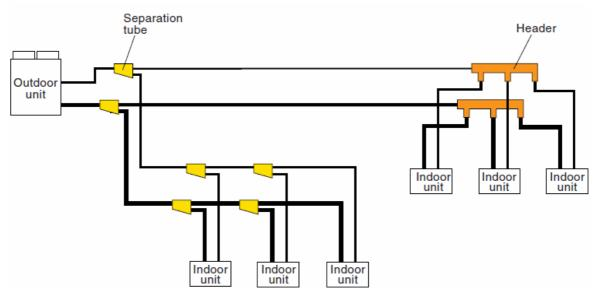
Figure 3.2 : Cooling Type VRF System
