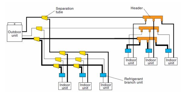
Figure 3.3 : Heat Recovery Type VRF System[8]
