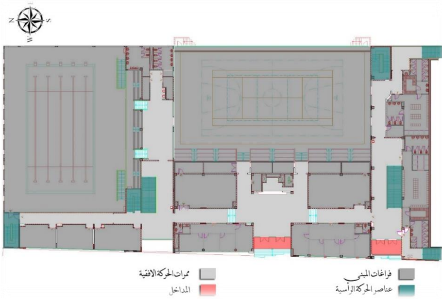
شكل ( 4-2 ) مخطط يبين المداخل وعناصر الحركة الرأسية والأفقية في الطابق الأرضي
