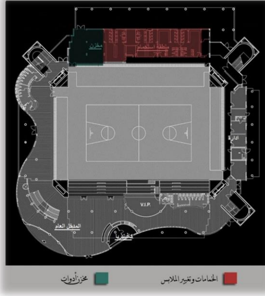
شكل رقم ( 4-14 ) مخطط يبين الفراغات الداخلية والنشاطات في الطابق الأرضي من الصالة الرياضية
