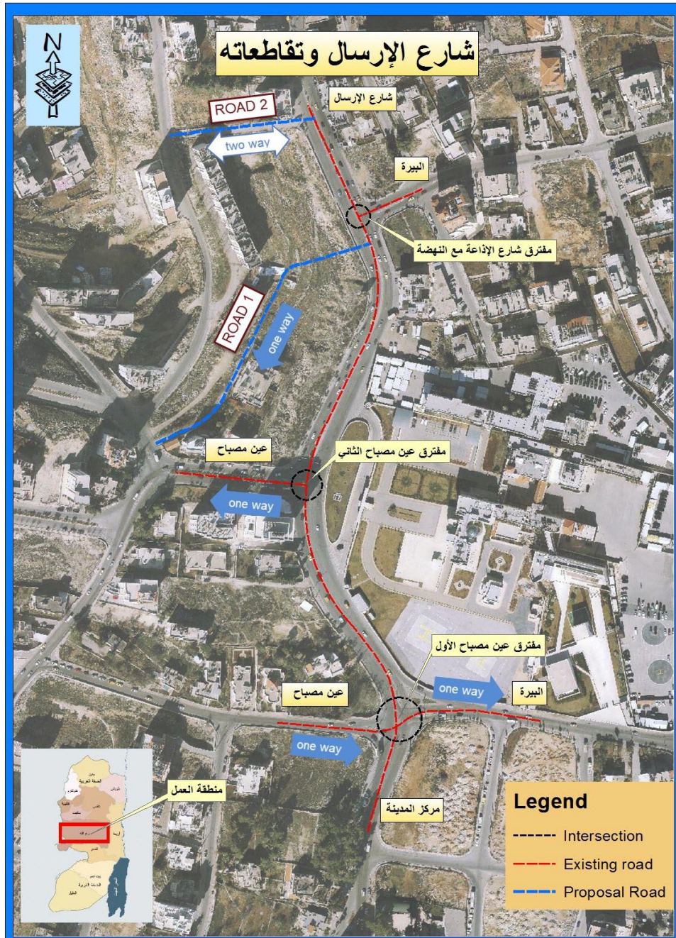
شكل (5-13) مخطط يظهر الطرق المقترحة لشق و طبيعة الطرق من حيث اتجاه الحركة
