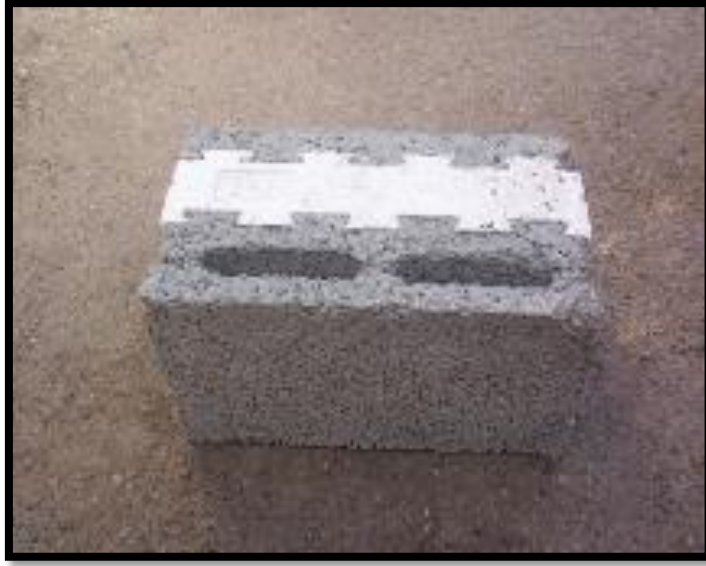
الشكل (1.4): طوبة إسمنتية معزولة بعرض 20 سم تستخدم في بناء الجدران الخارجية، (عبد الهادي، 2013).
