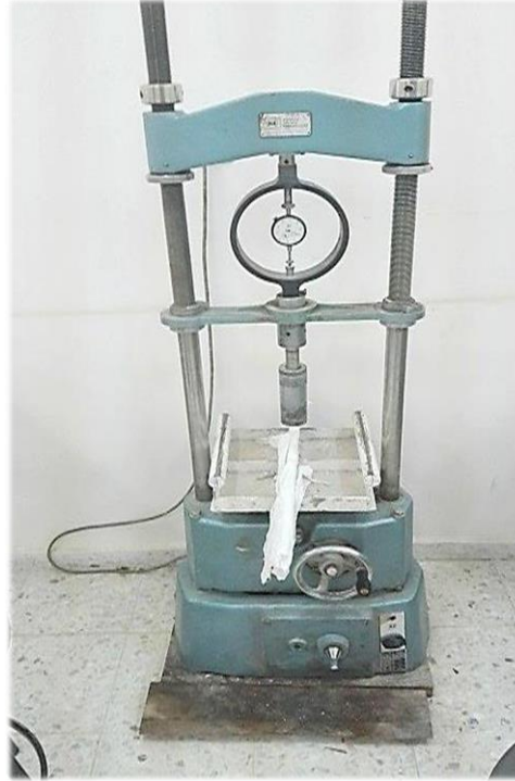
الشكل (4-5) جهاز فحص CBR .
