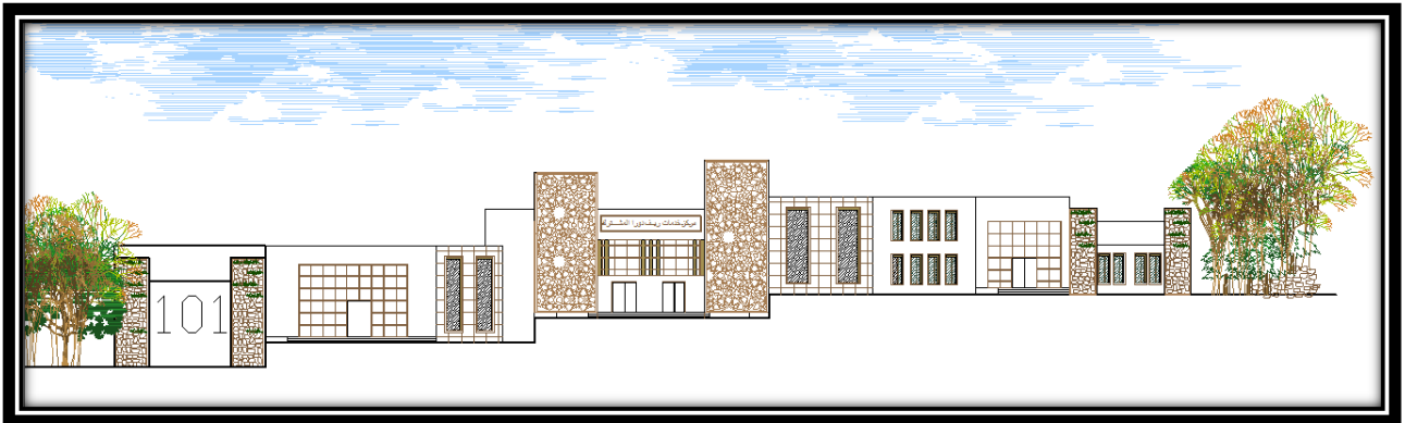
(5-8): صورة توضح الواجهة الجنوبية للمبنى وهي الواجهة الرئيسة للمبنى وفيها توضح المداخل الرئيسية للكتل .
