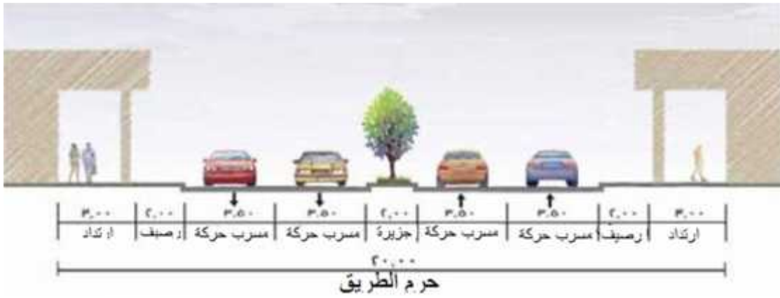
الشكل (5-6) قطاع الطريق
